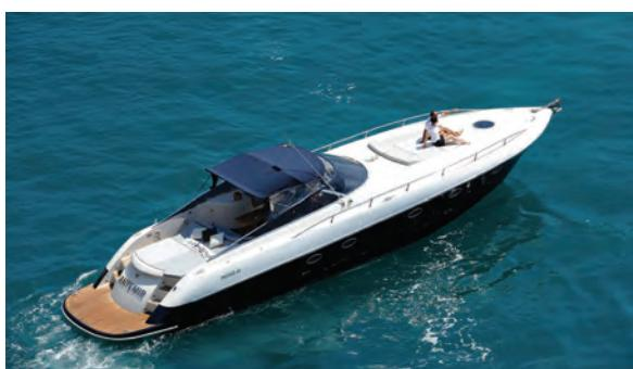
Lunghezza: 15,60 m (51 ft) • Larghezza: 3,74 mt • serbatoio acqua: 550 lt • serbatoio carburante: 1800 lt • Motori: Caterpillar D12 2x715cv • Generatori: 8 Kw • Velocità massima: 38 Kn • Velocità di crociera: 31 Kn
