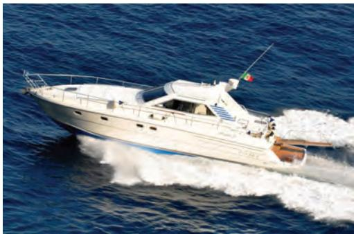
Lunghezza: 14,50 m (44 piedi) • Larghezza: 4,50 mt • Dislocamento: 13.05 t • serbatoio acqua: 1500 lt • serbatoio carburante: 1800 lt • Motori: 2x380 Hp • Generatori: 3,5 Kw • Velocità di crociera: 23 Kn • Velocità massima: 27 Kn
